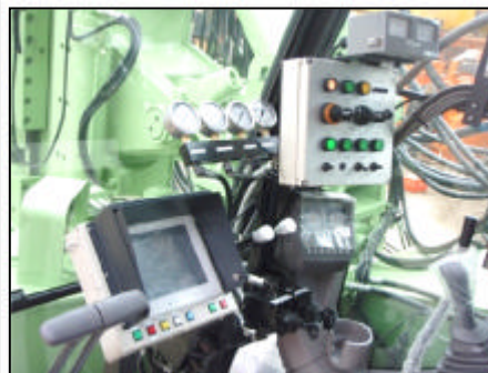
運転席 (操作盤+施工管理パネル)
