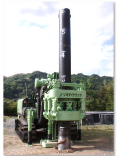
CHR 工法(小径つばさ杭施工機)
